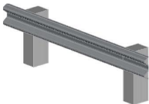
Рисунок 3 - Дорожное барьерное ограждение 1960-х гг.
